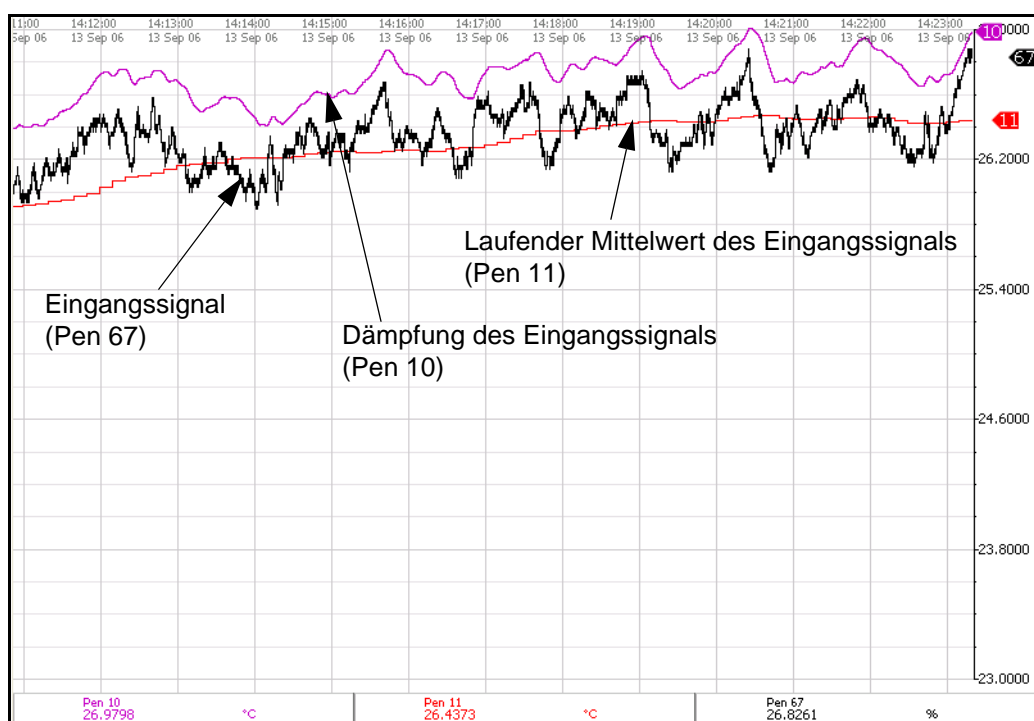
Abbildung 4.2 Auswirkungen von Dämpfung und laufendem Mittelwert (Beispiel)
