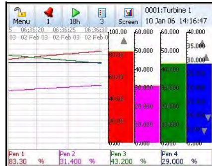
Horizontales Diagramm, 4 vertikale Balken und 4 Digitalanzeigen
